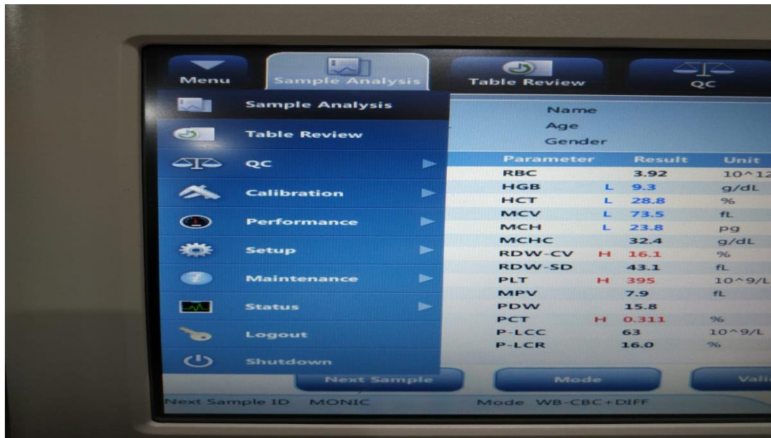
Gambar 2. Tekan [ENTER] untuk masuk ke layar Maintenance
